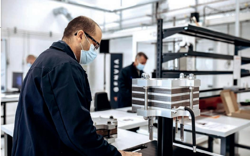
Atelier de montage de stacks de puissance pour la technologie d'électrolyse à haute température développée par Genvia.
